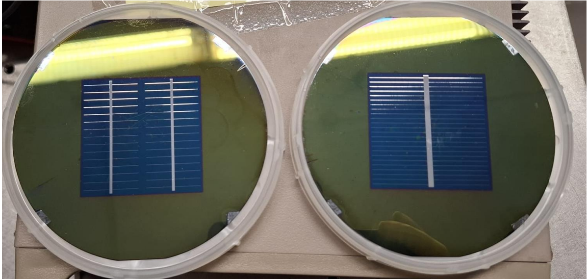
Figura 10. Celle solari realizzate su area circa 20 cm 2 con le nuove griglie metalliche.
