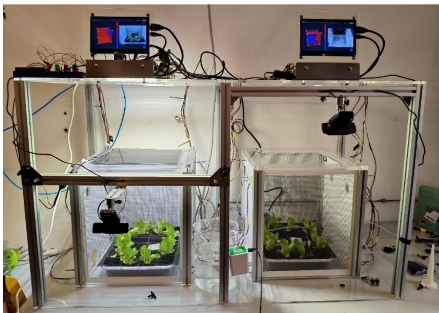
Figura 12 - Serra prototipale completa di struttura di alloggiamento moduli FV, lampade di illuminazione e attrezzatura di controllo e monitoraggio. Il prototipo comprende 2 mini-serre, una di test e una di controllo.
