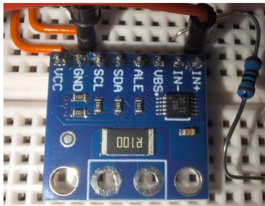
Figura 21- Modulo di power sensing. Si noti la "shunt resistance" per il monitoraggio della corrente.
