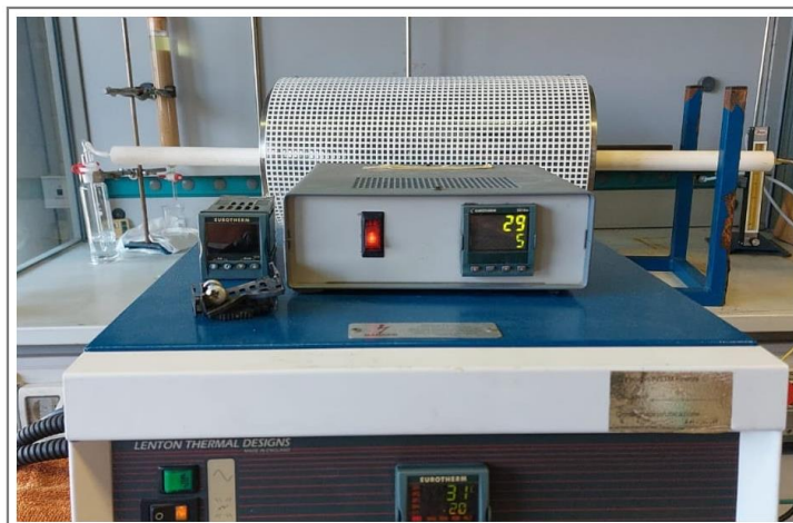
Figura 33 - Forno tubolare per cotture con raffreddamento rapido.
