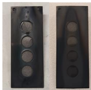
Figura 8. Il sistema di supporto degli elettrodi prima (a sinistra) e dopo la crescita (a destra)
