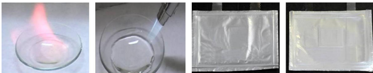
Figura 7 Test di ignizione (pannelli a sinistra) su solvente organico (infiammabile) e liquido ionico (non infiammabile). Celle elettrochimiche (pannelli a destra) poste a 100 °C contenenti solvente organico (incremento del volume della cella dovuto a volatilità)
