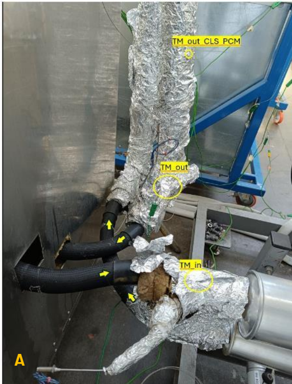
Figura 10: particolare dei flussi dell'olio in carica nei moduli da e per modulo cementizio (A), da e per modulo a calore latente (B).
