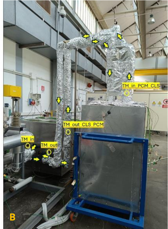
Figura 10: particolare dei flussi dell'olio in carica nei moduli da e per modulo cementizio (A), da e per modulo a calore latente (B).
