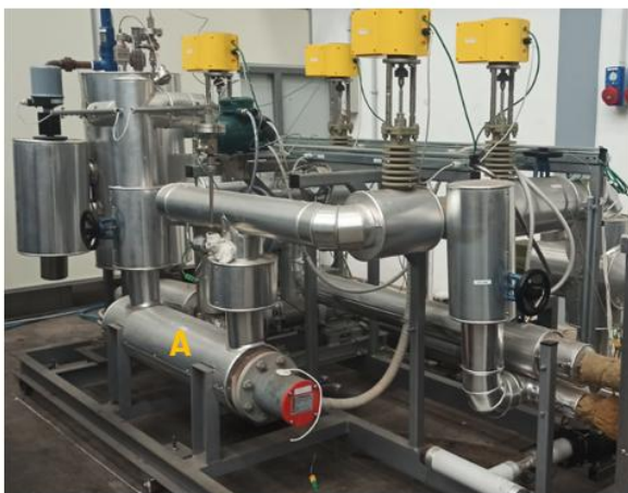
Figura 6: Solteca3 con riscaldatore (a) e raffreddatore preesistenti (b).
