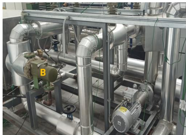
Figura 6: Solteca3 con riscaldatore (a) e raffreddatore preesistenti (b).
