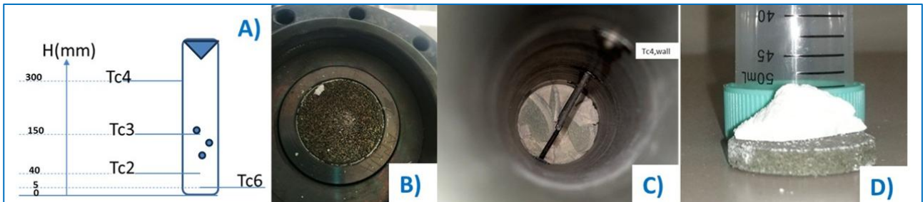
Figura 12. Rappresentazione schematica del reattore (A), particolari della flangia alta con il disco poroso (B), del reattore aperto (C) e del materiale compattato sotto al disco poroso (D).
