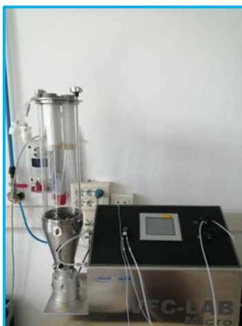
Figura 8. Particolare del granulatore spray-dry
