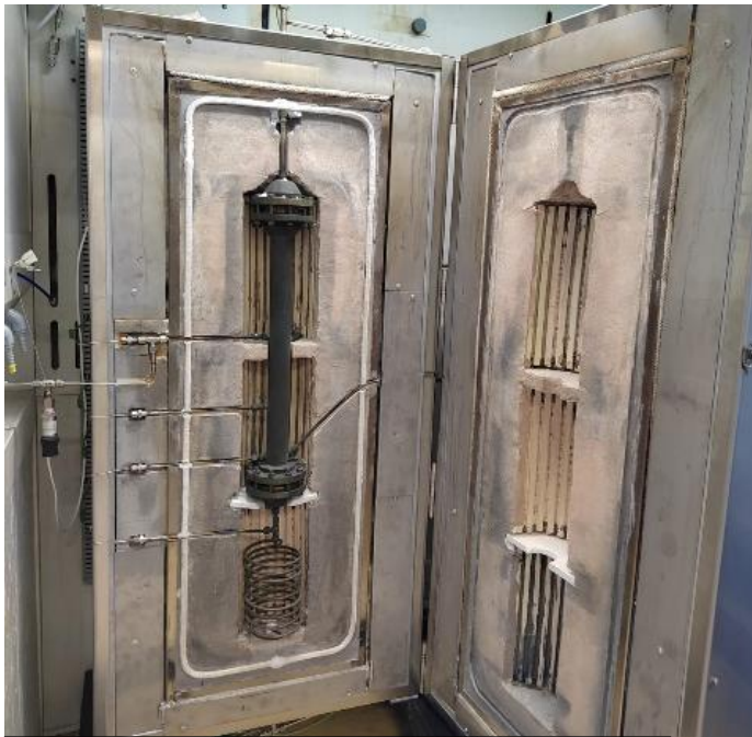
Reattore e preriscaldamento alloggiati nel forno ceramico
