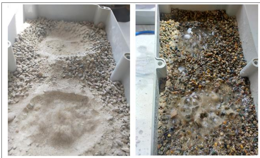
Figura 2: Primo test per la valutazione dell'efficienza degli ugelli: immissione di aria a portata variabile in terreno sia saturo (destra), sia insaturo (sinistra)
