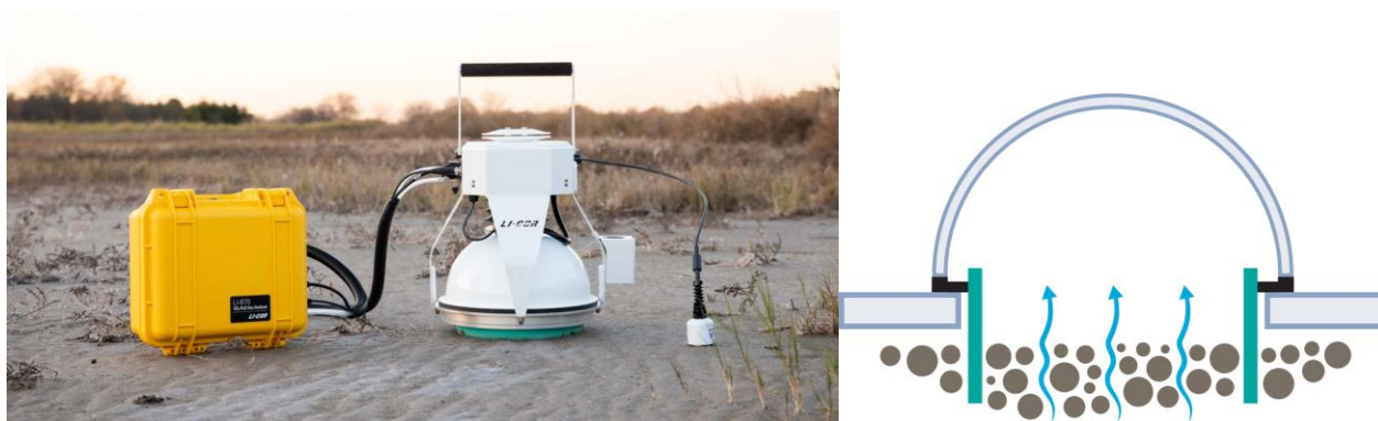
Fig. 7.2 – Camera di accumulo infissa nel terreno
