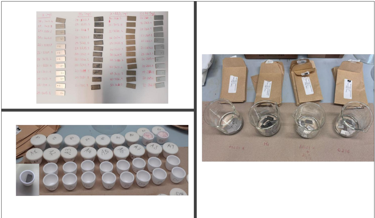
Figura 23 - Foto dei provini utilizzati per le prove di corrosione, suddivisi per tipo di acciaio, e i contenitori di allumina con tappo nei quali vengono inseriti.
