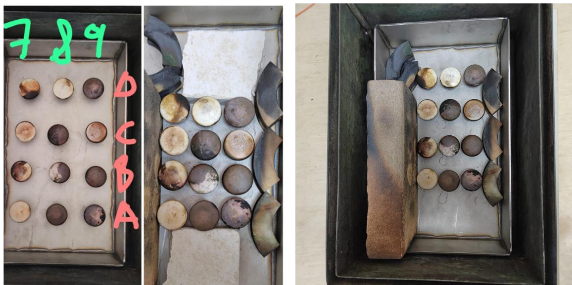
Figura 29 – Setup di corrosione riempito e pronto per il terzo campionamento (a sinistra); la storta riparata in cui è stato inserito un ulteriore vassoio di contenimento in Inconel 601 (a destra).
