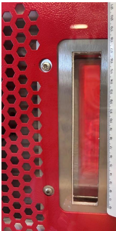
Figura 18 Test D - Altezza indicativa del bagno di sali fusi a 800°C.
