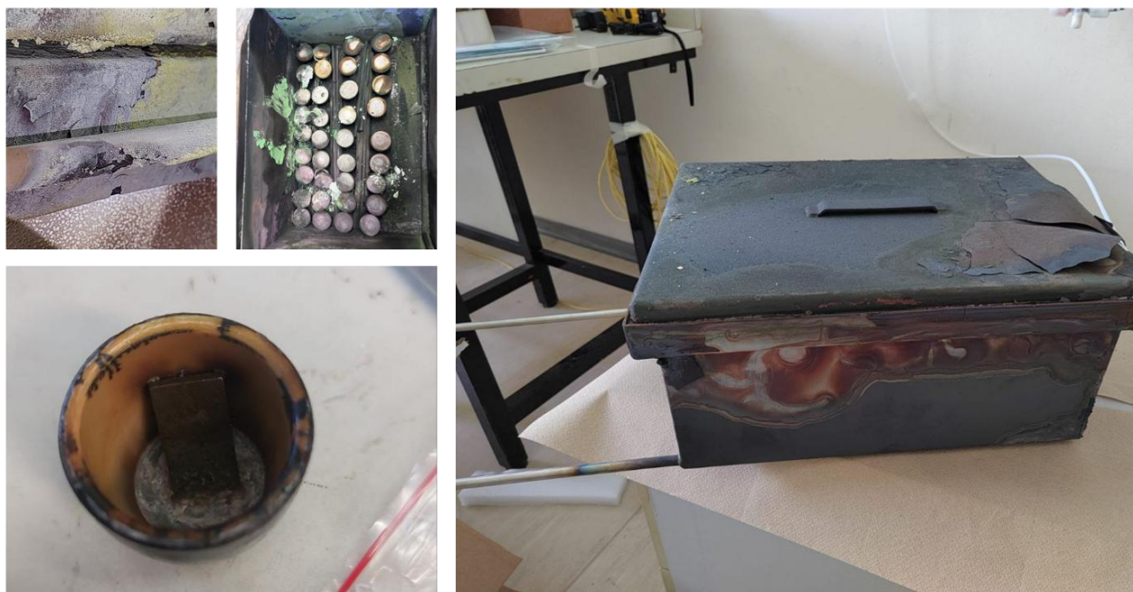
Figura 27 – Foto che evidenziano i danni provocati dalla volatilità della miscela di sale fuoriuscito dai crogioli: si osservano parti corrose e danneggiate e il sale uscito dall'interno dei crogioli
