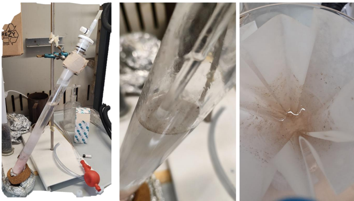
Figura 9 – Test A1 e A2: pirolisi del metano con reattore geometria #1 – fasi post reazione di lavaggio del reattore e recupero per filtrazione dei prodotti carboniosi
