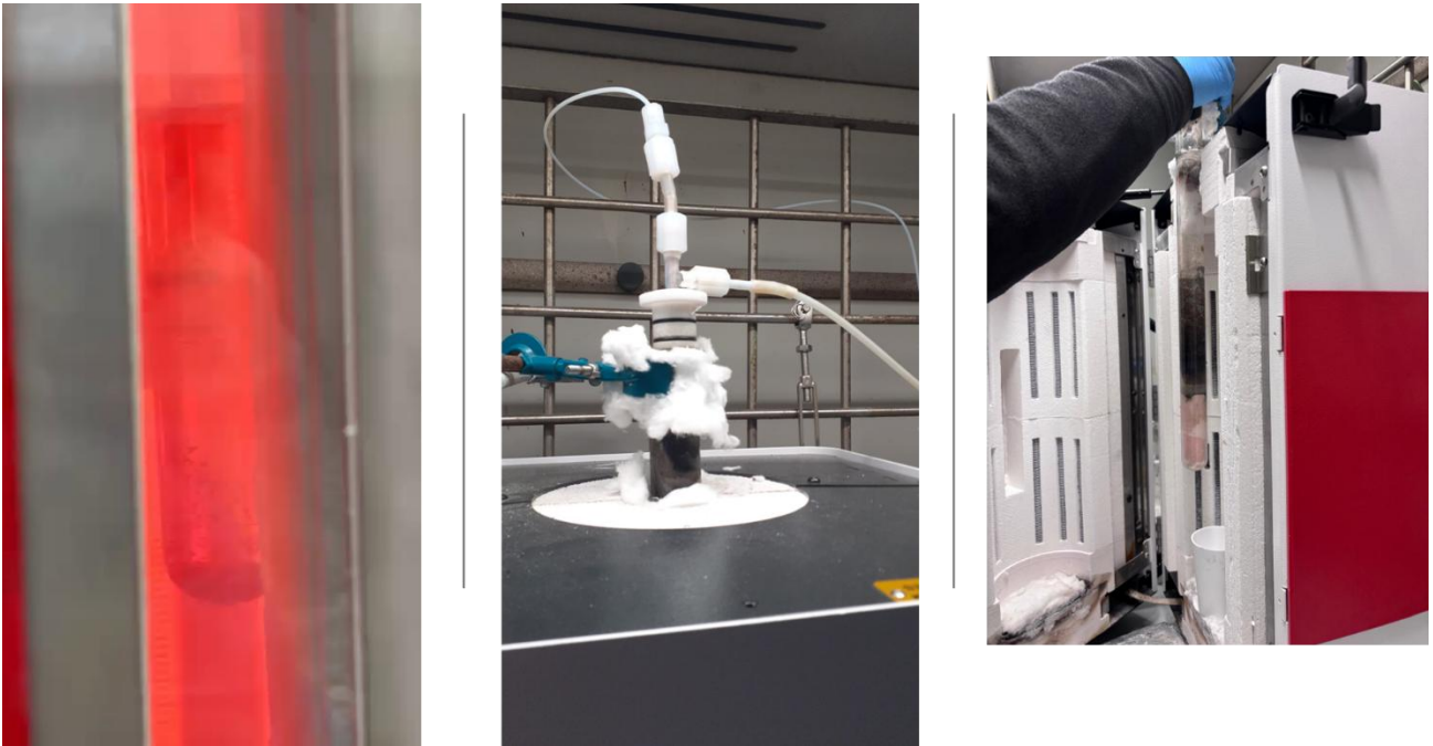
Figura 10 - Immagini rappresentative del test B con il reattore geometria#1: da sinistra, la finestra di quarzo del forno a 900°C in cui si vede il fondo del reattore con lo sparger immerso nel sale, il tappo fuoriuscito a causa dell'occlusione del tubo nella parte superiore e il reattore ormai freddo a fine test, in cui si distingue la parte di prodotti solidi carboniosi sopra il livello del sale congelato.
