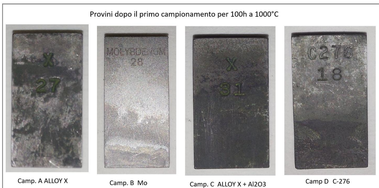
Figura 3 - Foto dei provini dopo il campionamento per 100h a 1000°C
