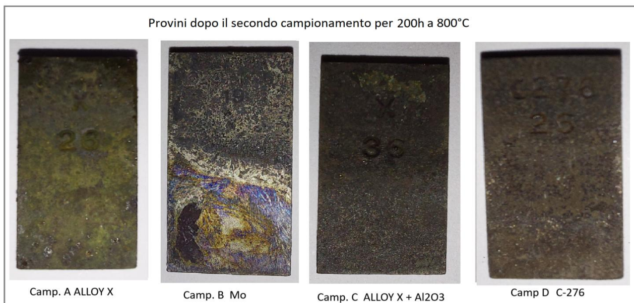
Figura 16 - Foto dei provini dopo il campionamento per 200h a 800°C
