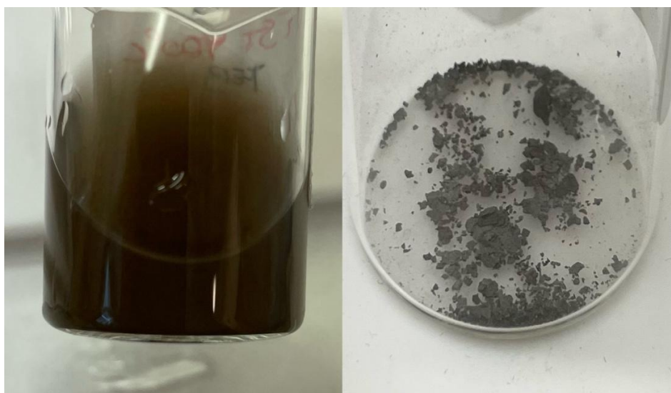
Figura 2 - Polvere del campione B come ricevuta da LA 1.6 in EtOH dopo sonicazione (sinistra) e dopo essere stato portato a secco (destra).
