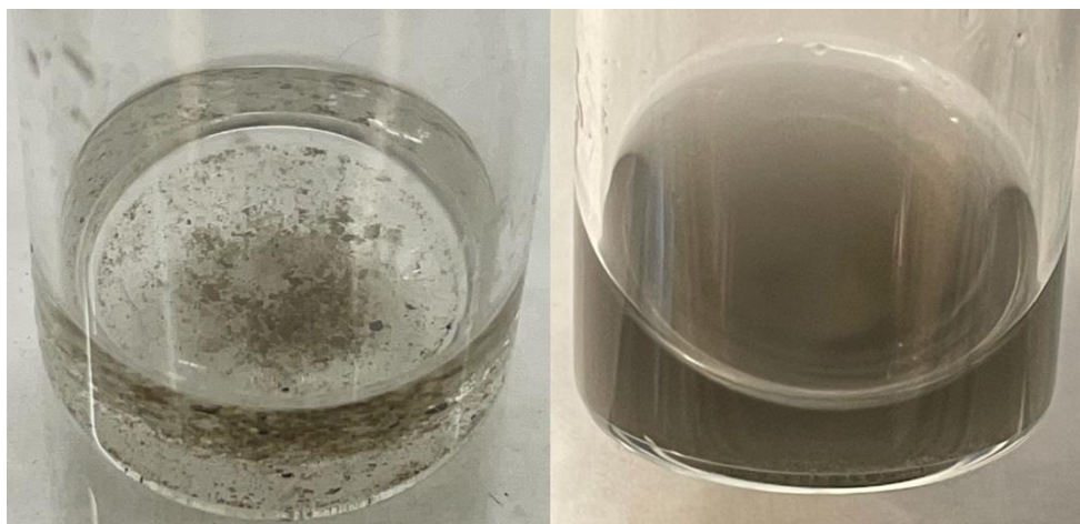
Figura 1 - Polvere del campione C come ricevuta da LA 1.6 in EtOH prima (sinistra) e dopo (destra) sonicazione.
