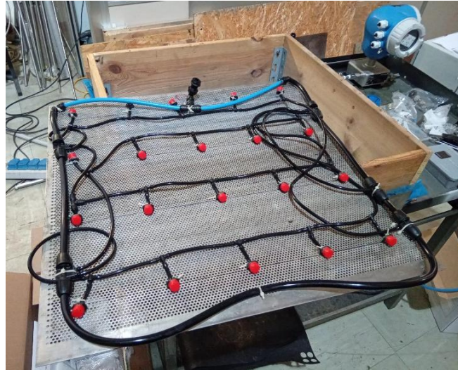
Figura 5. Distribuzione di ugelli e collettore su rete metallica. Nel setup la parte visibile in figura risulta rivolta verso il basso
