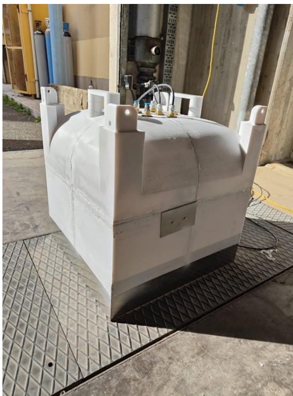
Figura 2. Captatore a superficie sommitale a volta a crociera
