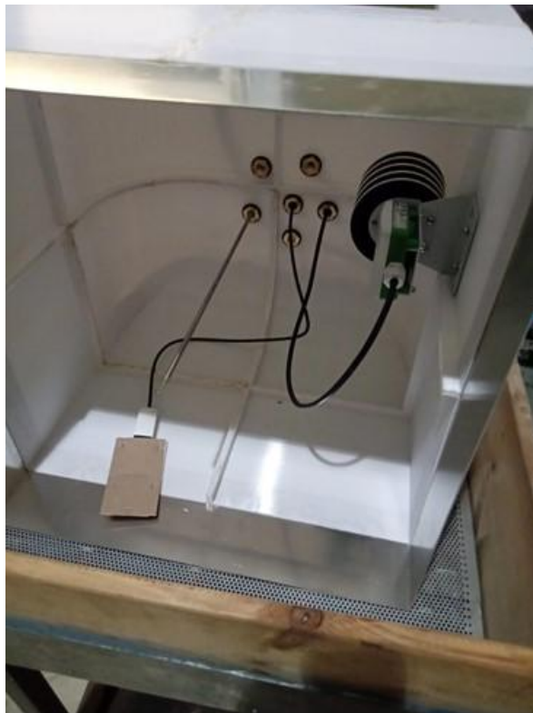
Figura 9. Sensori di temperatura e umidità relativa di terreno (TT-02, RH-02) e ambiente (TT-03, RH-01), questi ultimi protetti da schermo anti-radiazione
