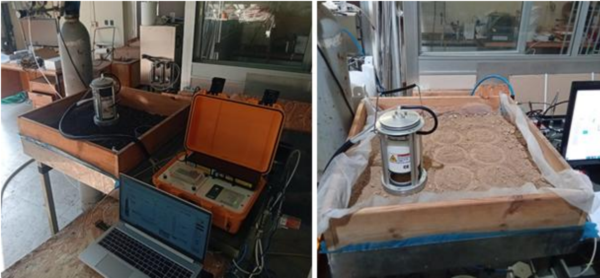
Figura 14. Campana di acquisizione LI-8100 A (LI-COR® Biosciences) disposta su ogni punto della matrice di prova (a destra tufo, a sinistra terriccio)
