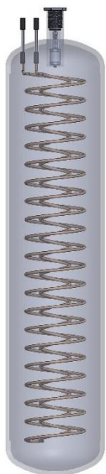
Figura 9 – Modello 3D di serbatoio a idruri metallici (sinistra) e relativi parametri caratteristici (destra).
