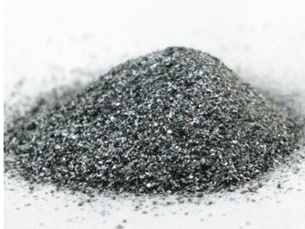
Figura 6 - Polvere di Idruro metallico Hydralloy C5
