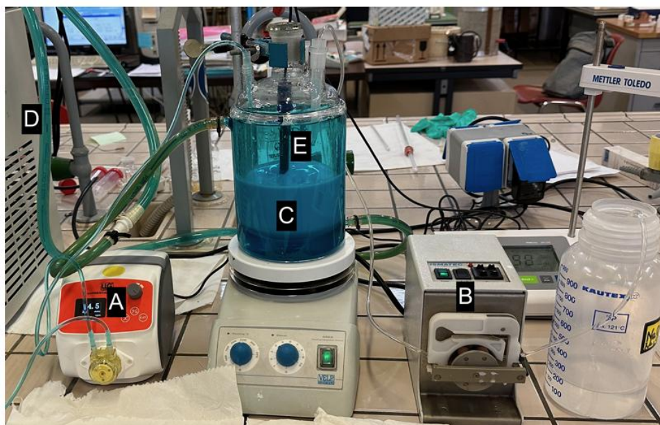
Figura 7.1 – Apparecchiatura assemblata in laboratorio per la produzione di quantità elevate dell'ossido misto di composizione selezionata. A: pompa peristaltica per l'alimentazione della soluzione di nitrati metallici; B: pompa peristaltica per l'alimentazione della soluzione basica; C: reattore incamiciato; D: fluido termostatico; E: elettrodo e termocoppia
