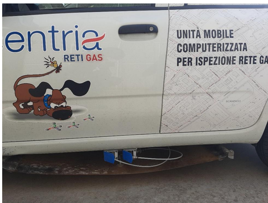
Figura 5 – Sensori di misura delle fughe gas posti sul pianale dell'autovettura
