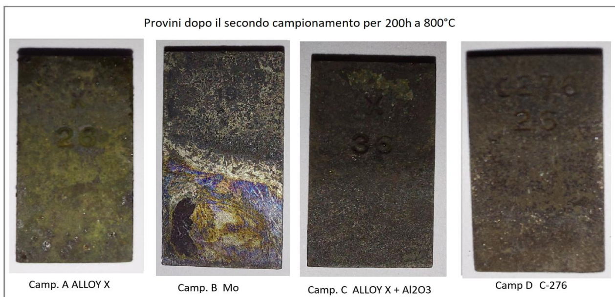
Figura 23 - Foto dei provini dopo il campionamento per 200h a 800°C
