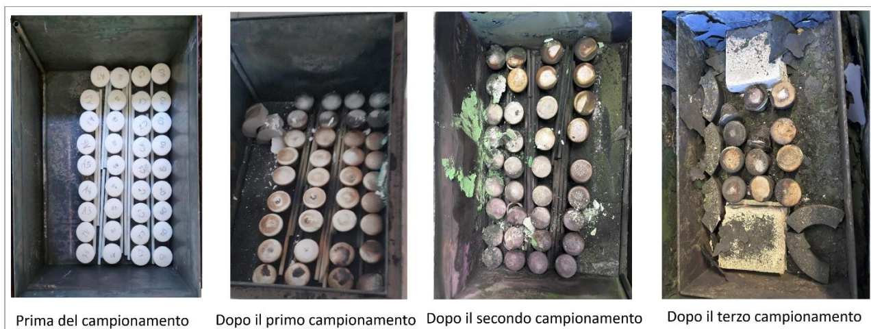
Figura 5 – Foto della storta e dei crogioli prima del test e dopo ogni campionamento.
