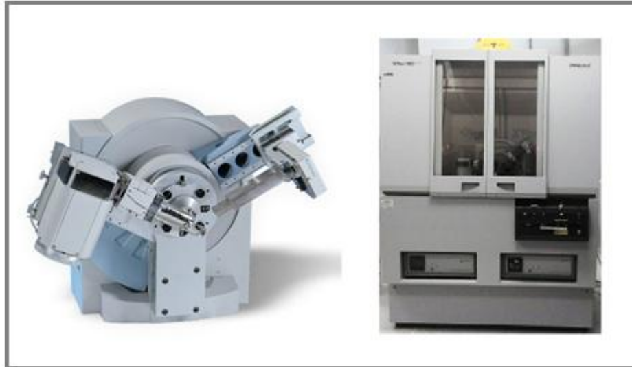
Figura 2 - Diffrattometro Bragg Brentano Philips X'Pert PRO
