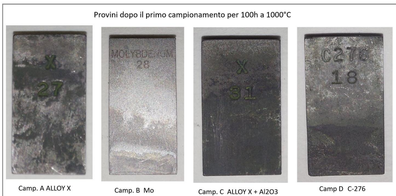
Figura 10 - Foto dei provini dopo il campionamento per 100h a 1000°C
