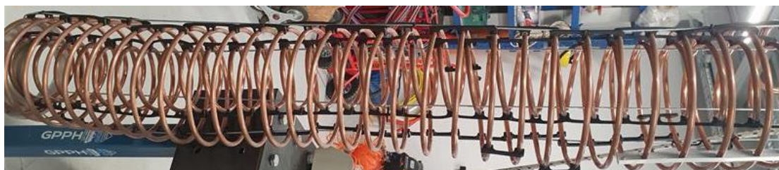
Figura 27 – Spirale integrata nel serbatoio con idruri metallici
