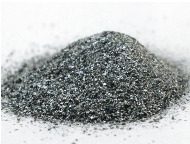
Figura 18. Polvere di Idruro metallico Hydralloy C5
