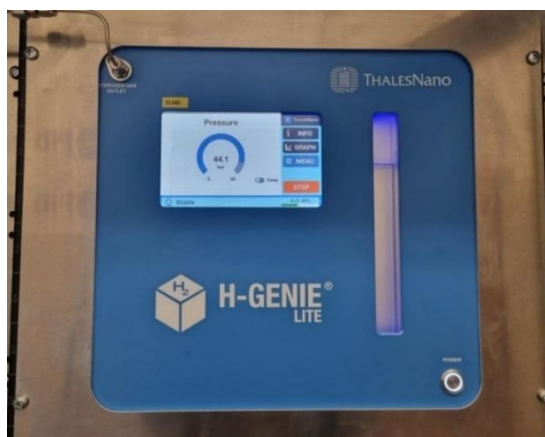
Figura 5.27 - Vista dell'elettrolizzatore PEM (EL-002) durante il test di pressione.
