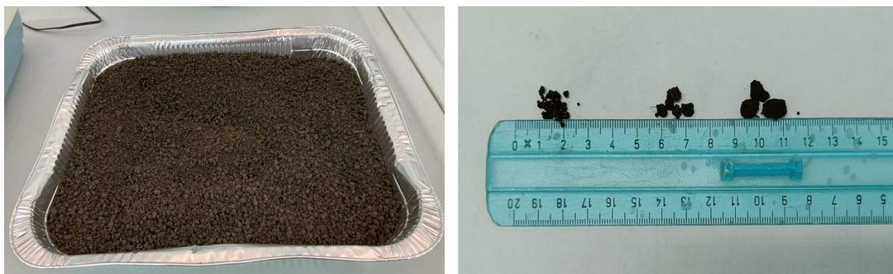
Figura 2.5 - Catalizzatore oggetto di scale-up granulato (sinistra) e visione in dettaglio dei granuli nei vari gruppi dimensionali (destra).
