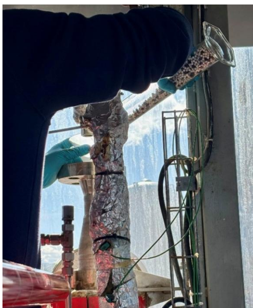
Figura 4.2 - Procedura di caricamento della miscela catalitica all'interno del reattore monotubolare.
