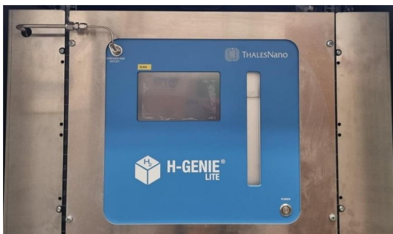
Figura 5.12 - Vista dell'elettrolizzatore PEM (EL-002).
