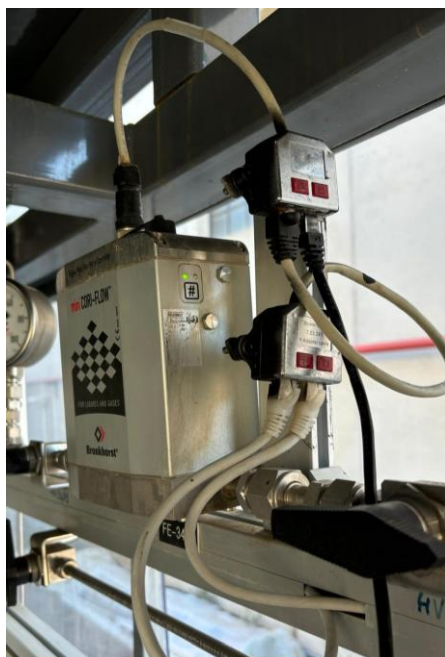
Figura 4.13 - Esempio di collegamento di un mass flow controller con degli Y-splitter dotati di attacchi RJ45.
