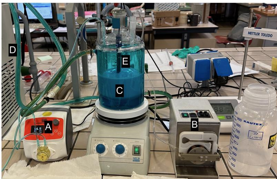
Figura 2.3 – Apparecchiatura assemblata in laboratorio per la produzione di quantità elevate dell'ossido misto di composizione selezionata. A: pompa peristaltica per l'alimentazione della soluzione di nitrati metallici; B: pompa peristaltica per l'alimentazione della soluzione basica; C: reattore incamiciato; D: fluido termostatico; E: elettrodo e termocoppia
