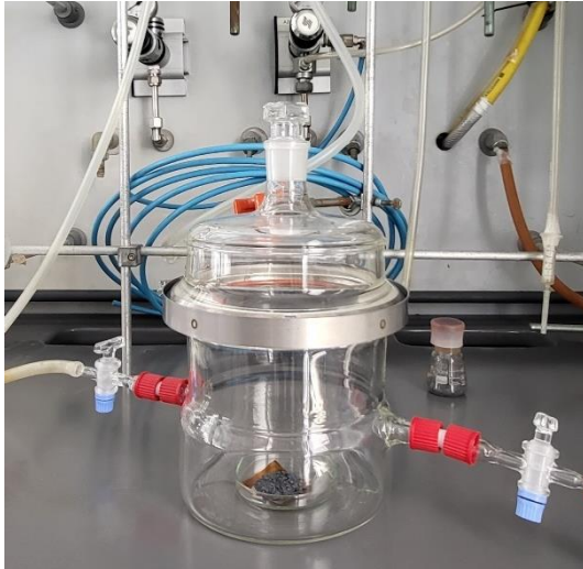
Figura 1- a) Camera reattore in vetro acquisita per il processo di iodurazione con iodio solido. b) Forno di essiccazione in vetro per il trattamento termico in atmosfera inerte di azoto
