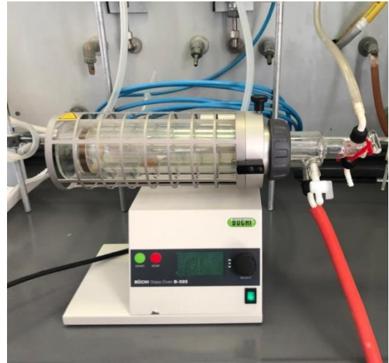
Figura 1- a) Camera reattore in vetro acquisita per il processo di iodurazione con iodio solido. b) Forno di essiccazione in vetro per il trattamento termico in atmosfera inerte di azoto
