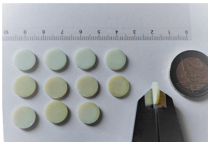
Figura 5. Validazione di tipici provini di ZnO dopo sinterizzazione
