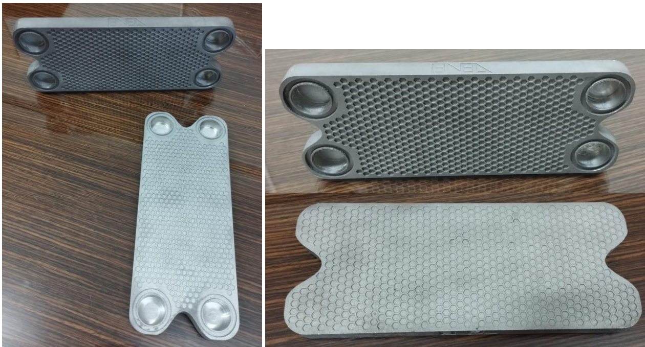
Figura 1: scambiatore di calore alleggerito realizzato mediante additive manufacturing in un unico blocco
