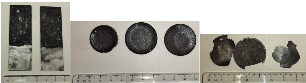
Figura 13: campioni depositati su vetro e in stampi con concentrazione di grafite pari al 5 e al 20% in peso
