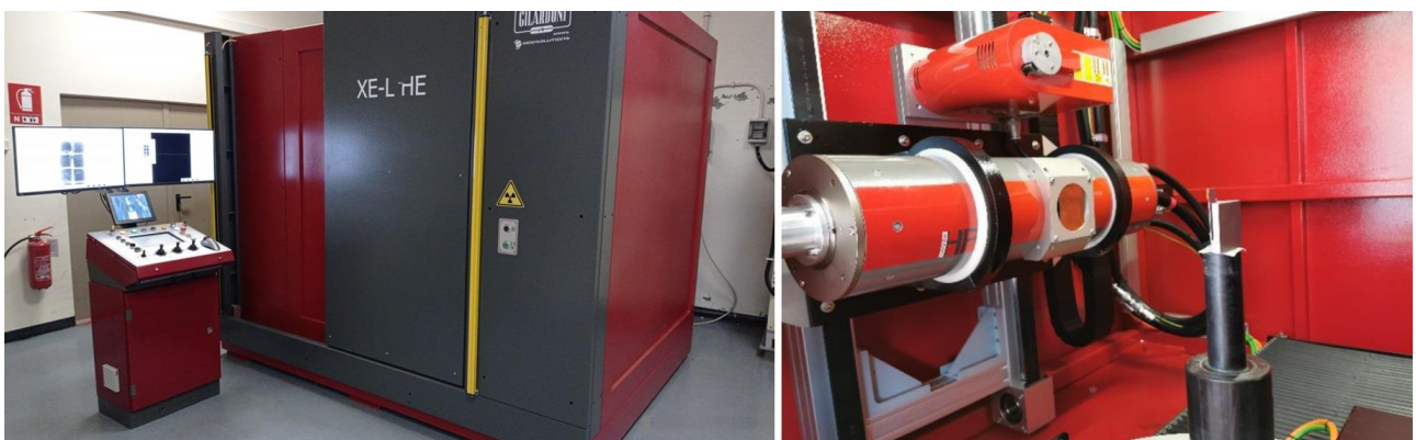
Figura 14: cabina tomografica e le 2 sorgenti radiografiche
