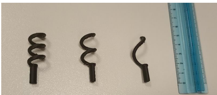
Figura 2. Fotografia dei prototipi di elettrodi stampati in PLA attraverso tecnica FDM, ricoperti da Nafion attivo.
