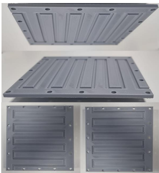
Figura 4. Fotografia di un prototipo di cella in flusso stampato in PLA attraverso tecnica FDM
