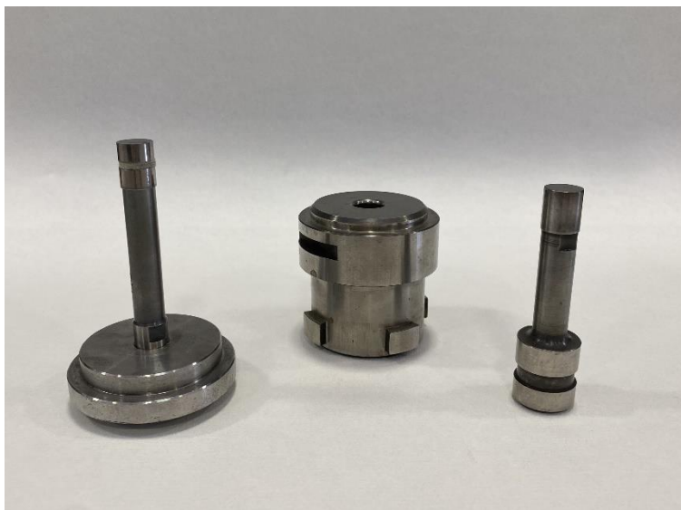
Figura 4. Stampo per pressatura uniaassiale
