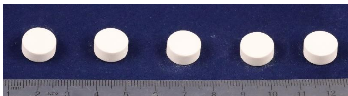
Figura 5. Campioni "verdi" dopo pressatura
