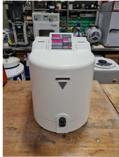
Figura 29. Mulino planetario Pulverisette 6 (Fritsch)
