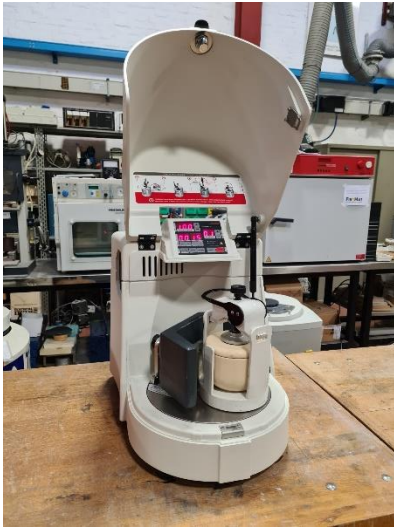
Figura 29. Mulino planetario Pulverisette 6 (Fritsch)
