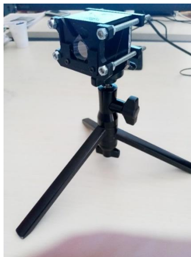
Figura 6 - Foto della sfera integratrice con vetrino inserito
