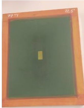
Figura 2. Telaio serigrafico per la deposizione di strati di SWCNT da pasta ottenuta per dispersione in acetone.
