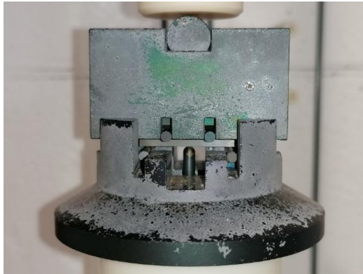
Figura 24- Sistema di prova per la flessione a 4 punti
