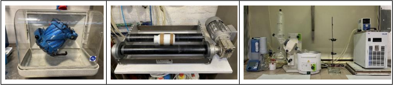
Figura 1 - Fasi preparative della polvere ceramica: macinazione ed essiccamento
