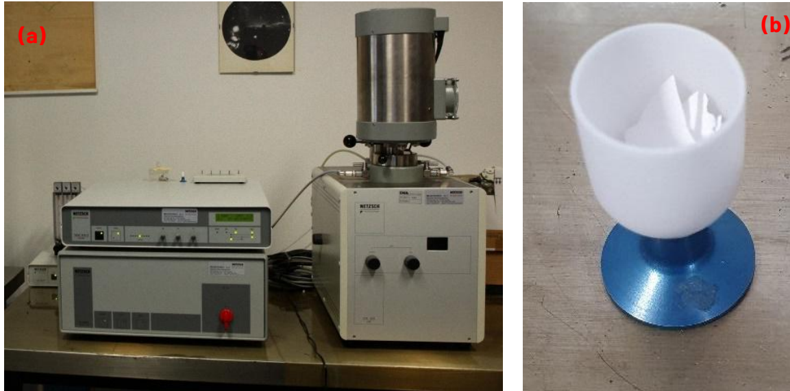
Figura 11 - Immagine della STA Netzsch, T_{max} = 1650\text{ }^{\circ}\text{C} (a); crogiolo con campione ceramico dopo TGA (b)
