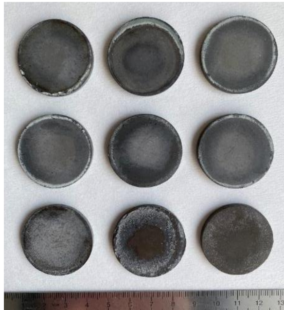
Figura 15 – Esempi di provini di SIN-AM sinterizzati, ottenuti con metodo convenzionale.
