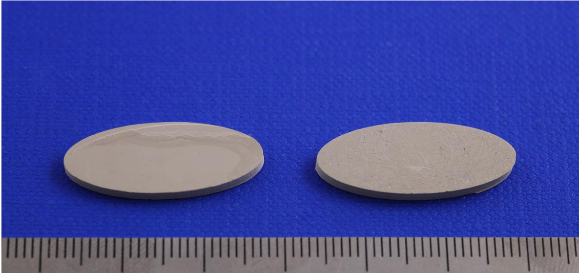
Figura 41 -Dimostratori di forma ellittica stampati da file STL
