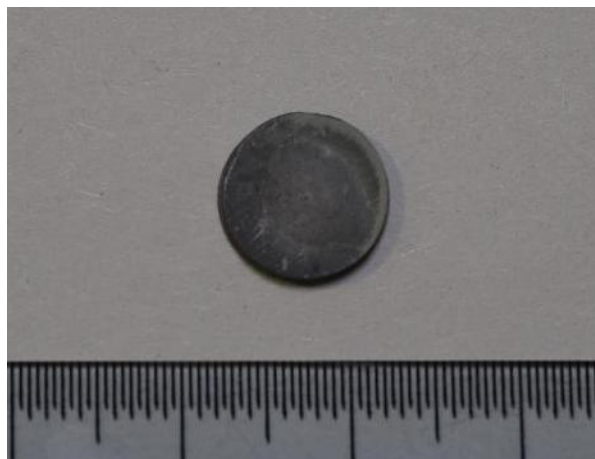
Figura 14 - Esempio di provino di SIN-AM sinterizzato, ottenuto da stampa 3D.
