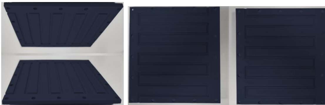
Figura 4. Fotografie di una cella in flusso stampata attraverso tecnica FDM
