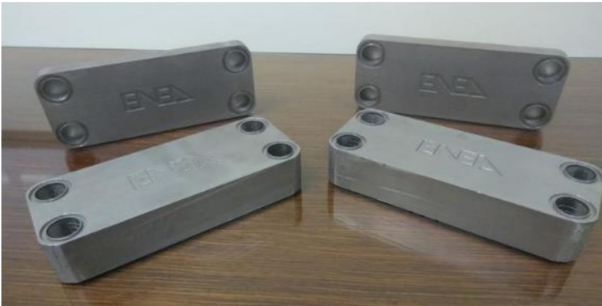
Figura 1: scambiatori di calore, a 2 e 7 canali, realizzati in acciaio inox nel PTR 2019-2021 mediante processi DMLS
