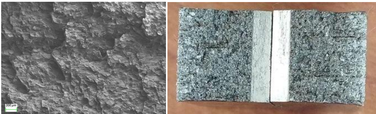
Figura 5: immagine SEM della superficie di frattura del campione per resilienza ottenuto da laminati (sinistra) e di quello ottenuto mediante manifattura additiva (destra)
