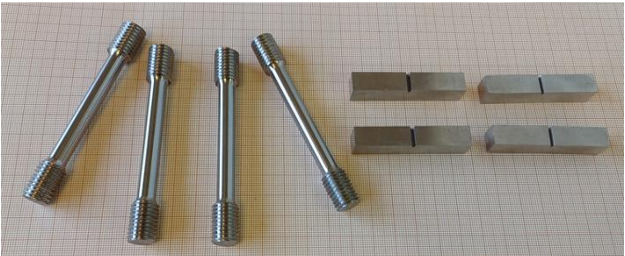
Figura 4: campioni in lega ferritica per prove di trazione e resilienza
