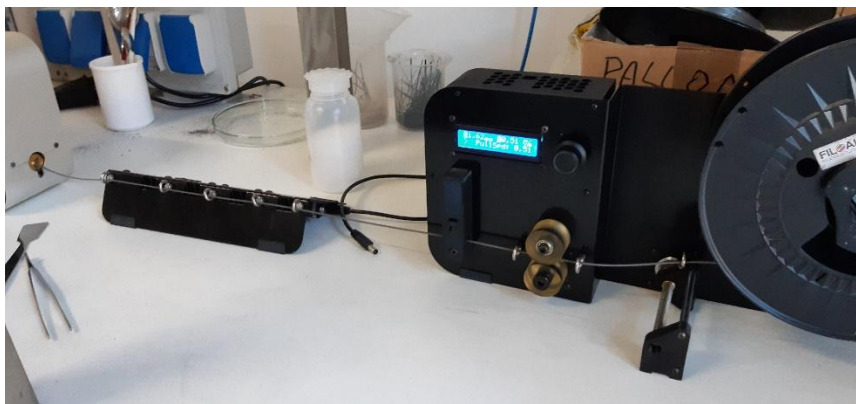
Figura 17 Fotografia dell'estrusione del filamento ad alto carico di polvere di acciaio 316L.
