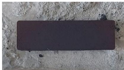
Figura 20 Provino di stampa 3D di dimensioni 20 x 12 x 7 mm ottenuto da filamento polimero/acciaio 316L home-made.
