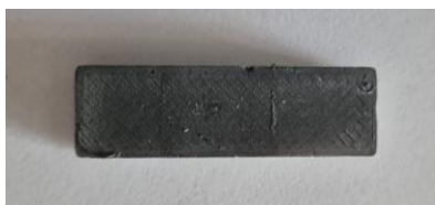
Figura 21 Provino di stampa 3D realizzato con filamento homemade, sinterizzato ed utilizzato come elettrodo 3D-4.
