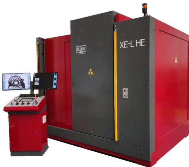
Figura 15: tomografo utilizzato per la ricostruzione della turbina e la verifica dei difetti.
