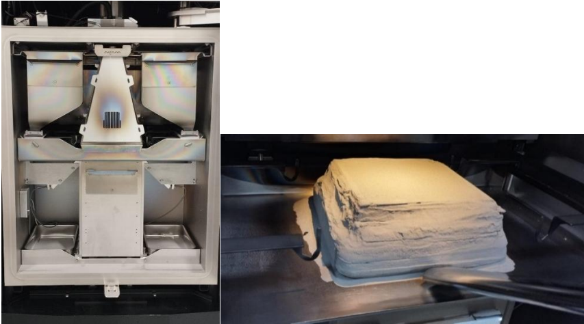
Figura 14: interno della stampante per metalli EBM Arcam A2X e fase di estrazione dei campioni stampati
