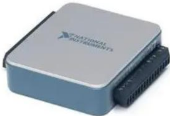
Figura 27: scheda di acquisizione USB-6000 della National Instruments
