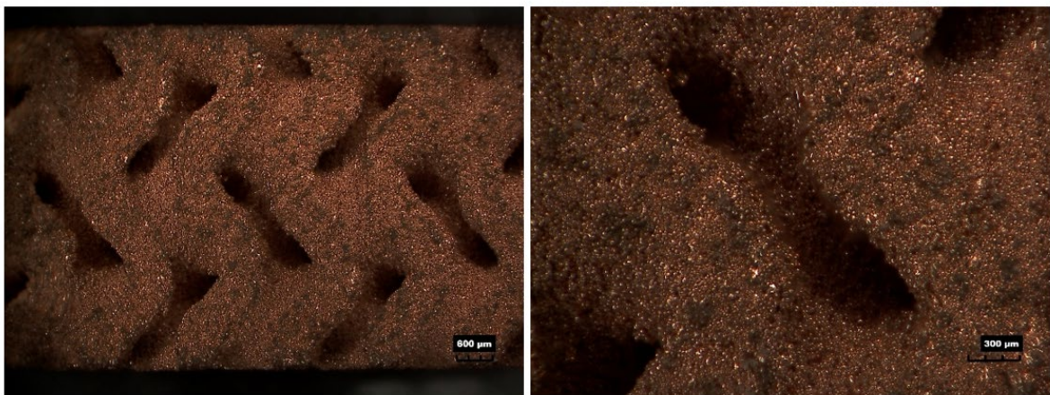
Figura 10 – Analisi microscopica delle strutture capillari di tipo lattice. a) struttura di tipo cross, b) struttura di tipo giroide.
