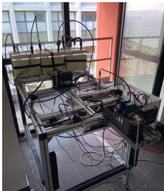
Figura 9. Sistema integrato refrigeratore-PCM realizzato in laboratorio.
