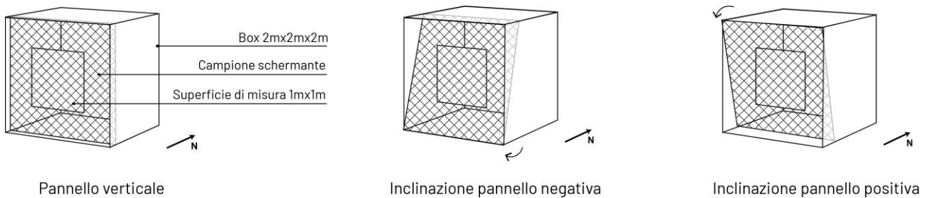
Figura 9 – Misure ed impostazioni della struttura di test virtuale realizzata in Rhino-Grasshopper per la valutazione speditiva delle prestazioni schermanti, con schematizzazione posizione campione verticale ed inclinato positivamente e negativamente. La dimensione del Box per campioni inclinati è qui indicativa, nella valutazione è stato considerato un box 6m x 6m per evitare effetti di bordo sulla superficie di misura
