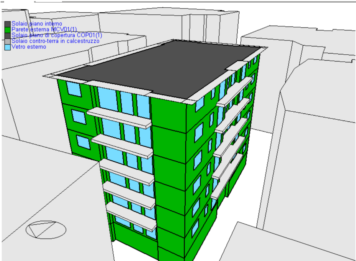
Figura 12 – Dettaglio dell'edificio di Roma simulato energeticamente in EnergyPlus con l'attribuzione dei componenti orizzontali e verticali
