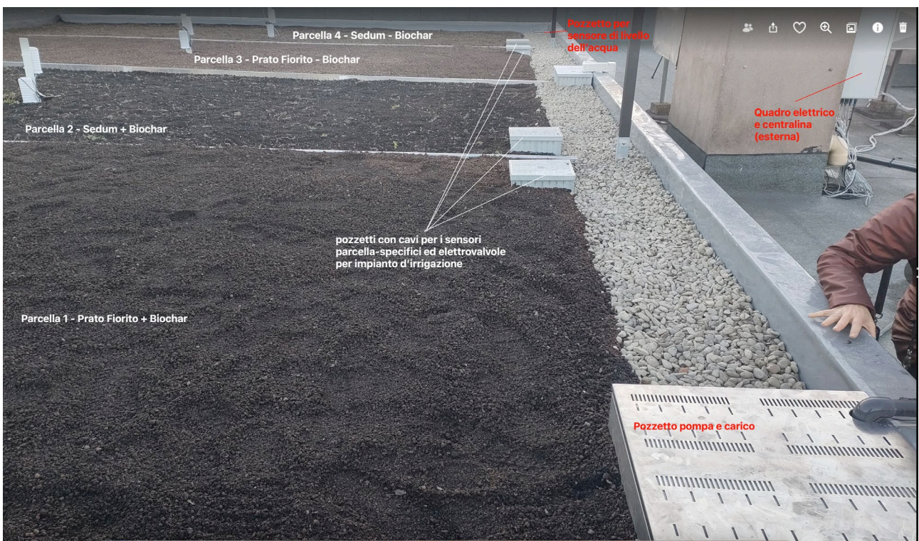
Figura 14 - Fotografia del campo prova del sistema BGR. Sono indicate le 4 differenti Parcelle, la posizione ed il contenuto dei diversi pozzetti, la centralina ed il quadro elettrico.
