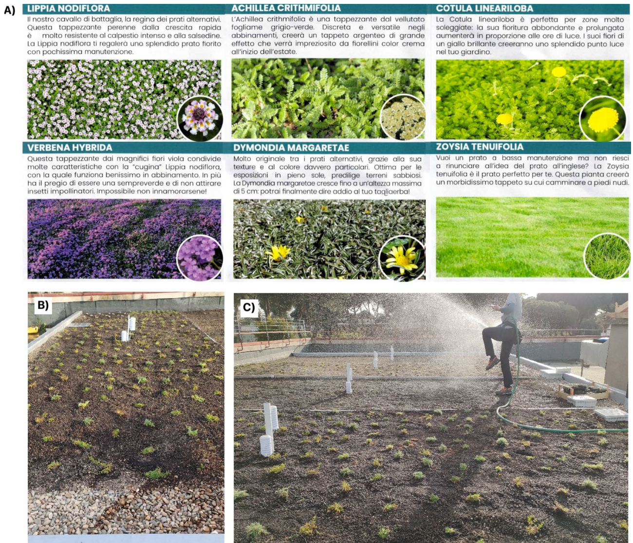
Figura 3 - A) Specie vegetali utilizzate per il prato fiorito. B) Fotografia della P1 a prato fiorito alla fine del trapianto delle piantine in data 15 marzo 2024. C) Prima irrigazione abbondante del campo prova, dall'alto con tubo, con P1 in primo piano
