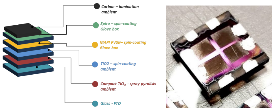
Fig. 4 Stack della cella PSC con elettrodo in carbonio/grafite laminato.
