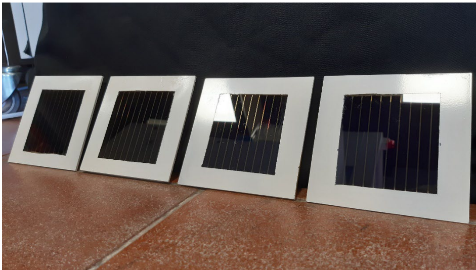
Fig. 1 Alcuni dei prototipi di moduli PSC sviluppati per l'integrazione nel sistema di energy harvesting e rilevazione ambientale.
