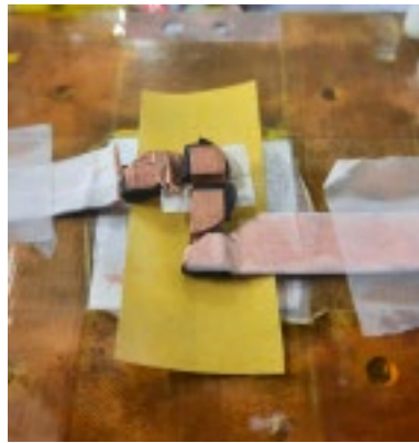
Figura 6: Modulo TEG 3D (pellet) basati su architettura unileg con polimeri semiconduttori intrinsecamente conduttivi n-type (Poly[Kx(Niett)])
