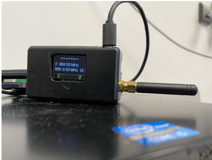
Figura 5 - Il gateway sviluppato per ricevere il messaggio spedito con tecnologia LoRa e ritrasmetterlo via WiFi ad un server remoto
