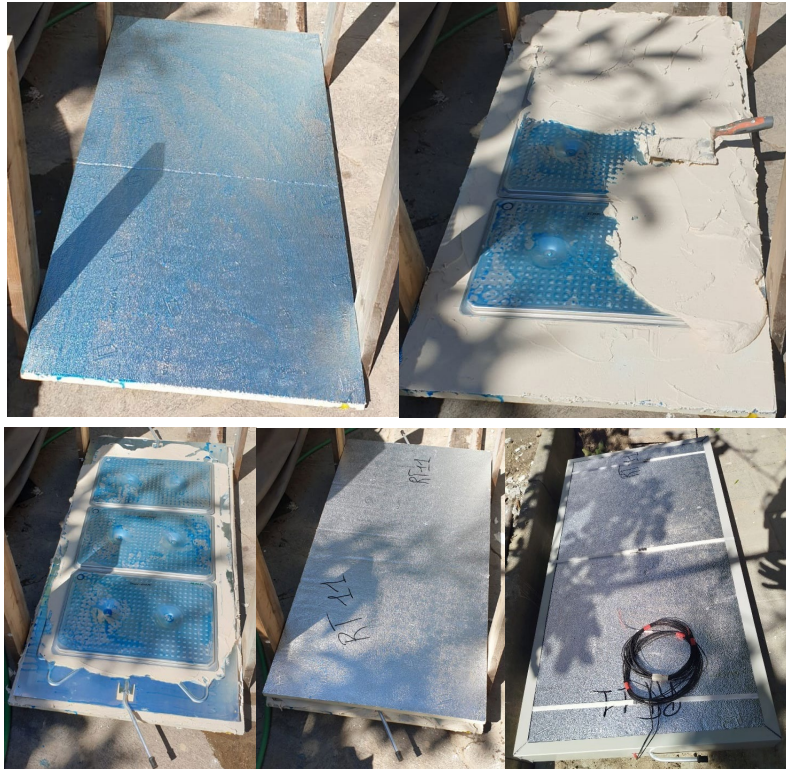
Figura 66 - Pannelli accumulo planari non integrati PCM Rubitherm RT 11 RT 35
