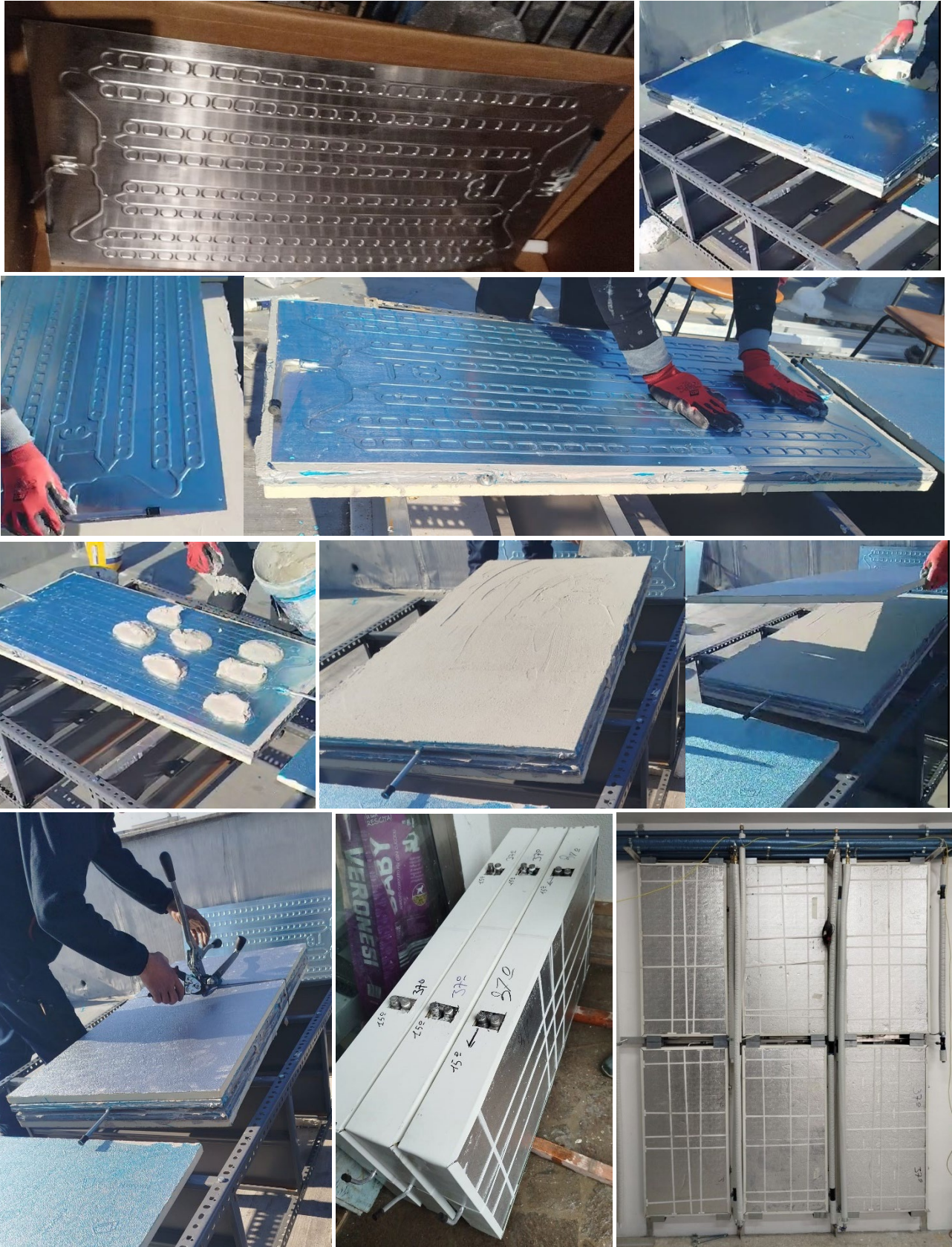
Figura 65 - Pannelli accumulo planari non integrati PCM Croda RT 15, RT 37
