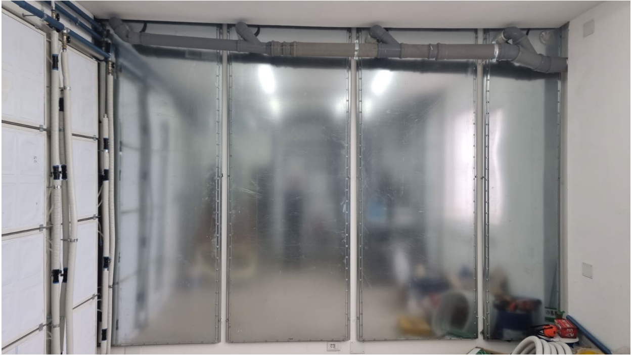
Figura 63 - Parete a trasmittanza termica variabile, Sud
