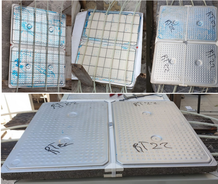
Figura 68 - Pannelli accumulo planari integrati PCM Rubitherm RT 22, 25
