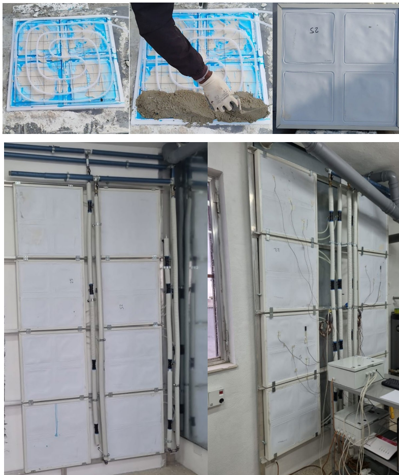
Figura 67 - Pannelli accumulo planari integrati PCM Templock 22, 25
