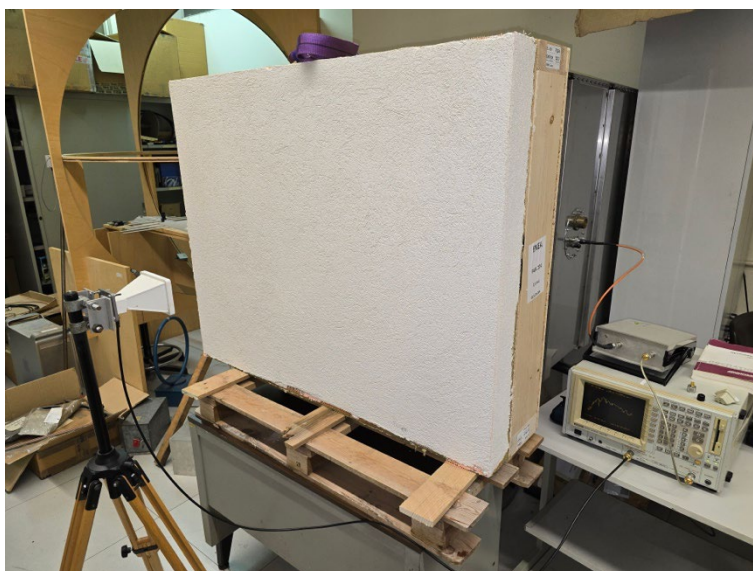
Figura 8 Misura della SE con antenne TX e RX in polarizzazione verticale in presenza di schermo.
