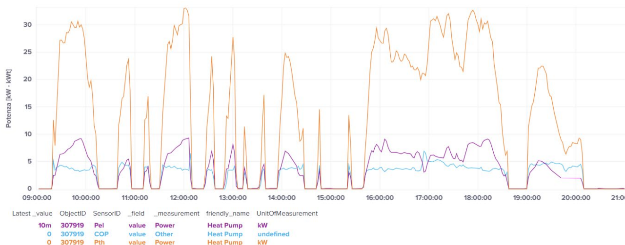
Figura 28 – Prova con ADLAS: andamento temporale della potenza termica prodotta dalla PdC (curva arancione - kWt), della potenza elettrica assorbita dalla PdC (curva blu - kW) e del relativo COP (curva celeste - u.a.).
