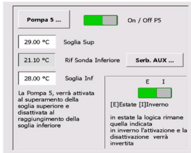
Figura 22: Pagina del software" Logica per l'Attivazione pompa P5
