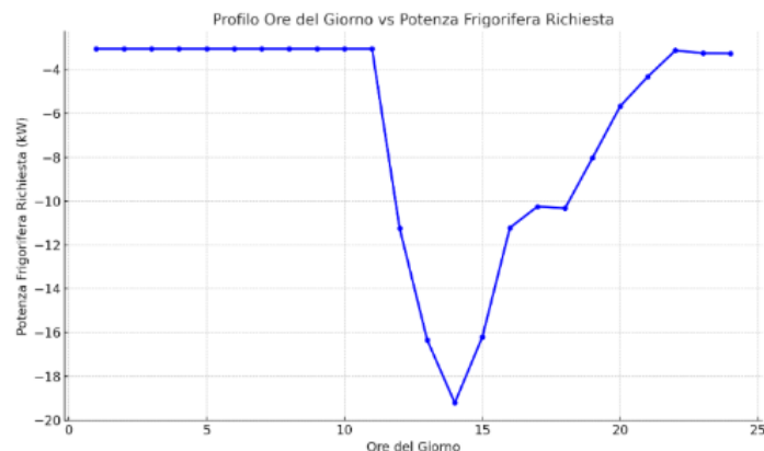
Figura 28-Andamento Potenza frigorifera richiesta in 24 ore dai locali della Cantina Vitivinicola simulata
