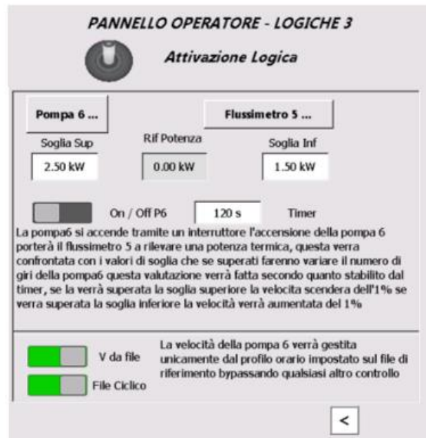
Figura 256–Pagina del software“ Logica per l’attivazione del circolatore P6”: sezione emulazione carico termico
