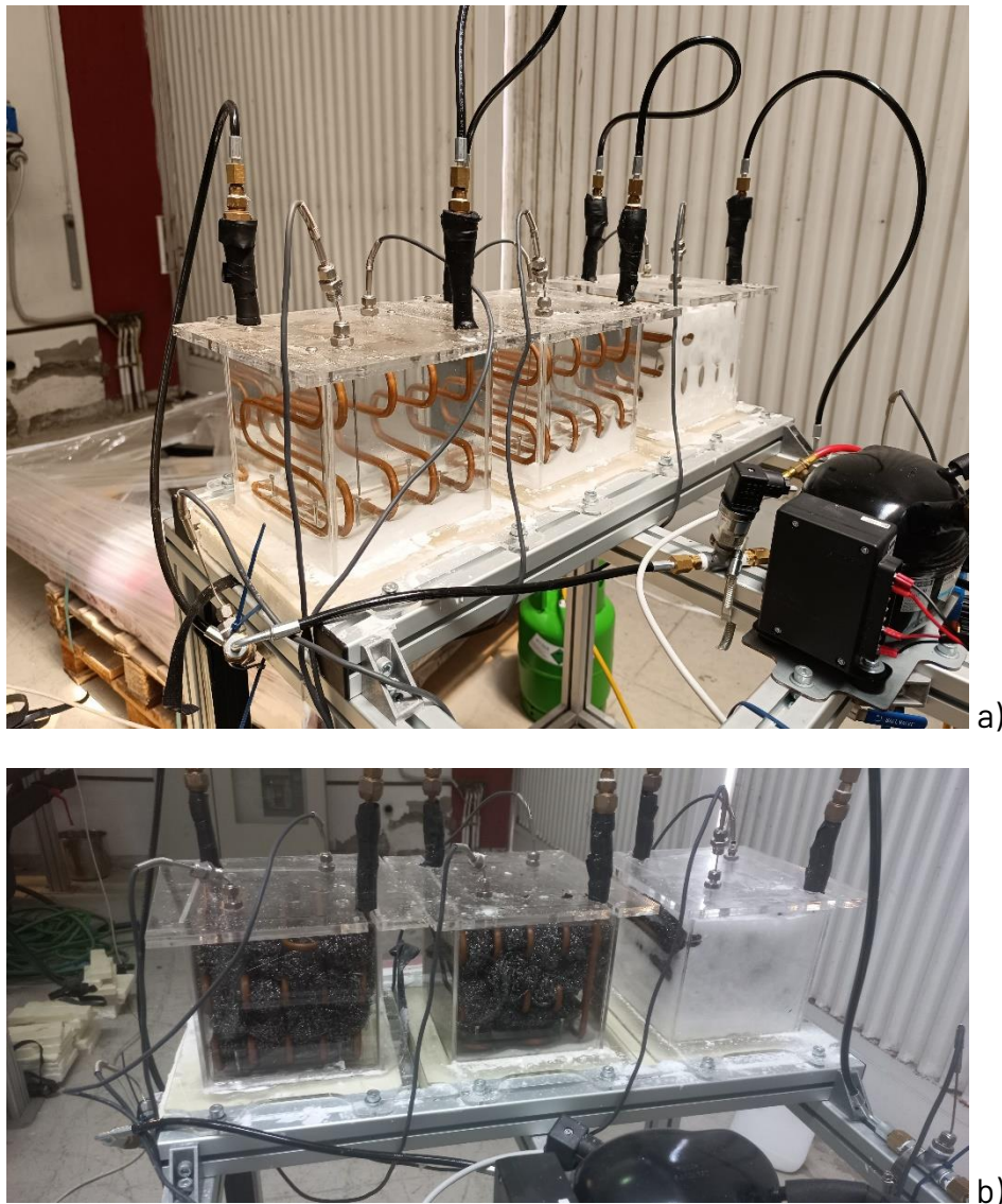
Figura 8 Particolare dei moduli del condensatore: a) senza schiuma metallica; b) con schiuma metallica
