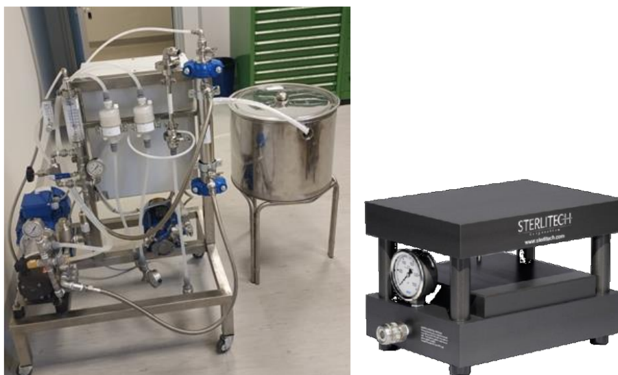
Figura 10 Sistema pilota per prove di filtrazione composto da modulo principale con doppio sistema di pressurizzazione (pompa di precarico fino a 4 bar e pompa ad alta pressione fino a 70 bar) per l'alimentazione delle membrane e modulo aggiuntivo configurato per l'utilizzo di membrane piane di diversa tipologia e taglio molecolare.
