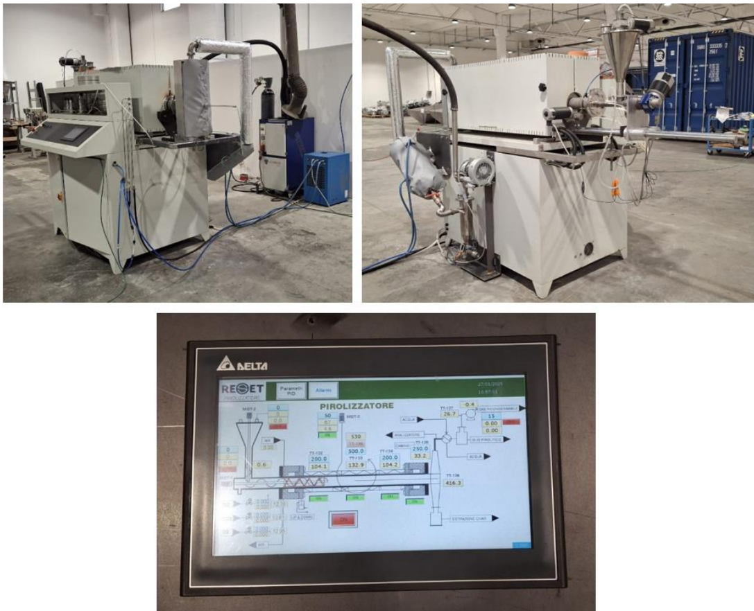
Figura 6 Impianto Fedora dopo intervento di upgrading: vista fronte, retro e pannello di controllo.
