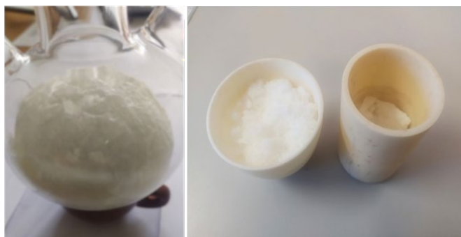
Figura 19 Spugna porosa di mayenite ottenuta per mescolamento di sali nitrati di Ca e Al.
