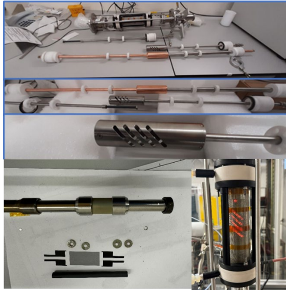
Figura 25 Fotografia del set-up che integra la membrana all'interno dell'elettrodo. Sopra il sistema di elettrodi. In basso a sinistra la membrana supportata, sigillata al supporto denso. A destra in basso il reattore durante le misure con solo riscaldamento indiretto.
