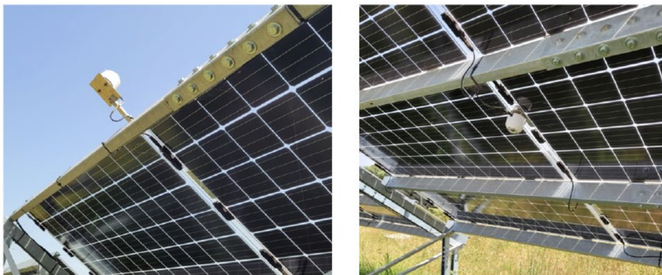
Figura 14. Piranometro per la misurazione della radiazione solare globale incidente sulle facce anteriore e posteriore del modulo bPV.
